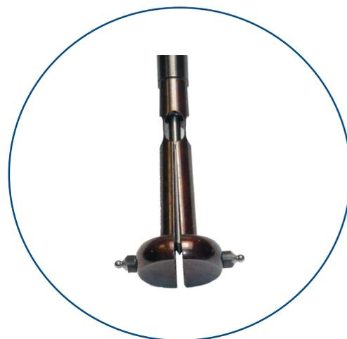
Messkopf mit Triebnadel und eingeschraubten Messkugeleinsätzen
