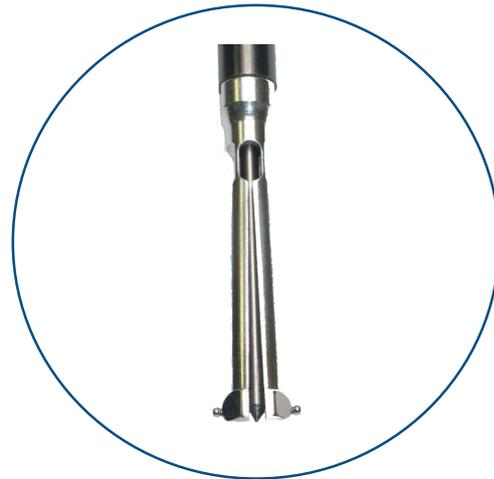
Messkopf mit Triebnadel und aufgelöteten Messkugeln
